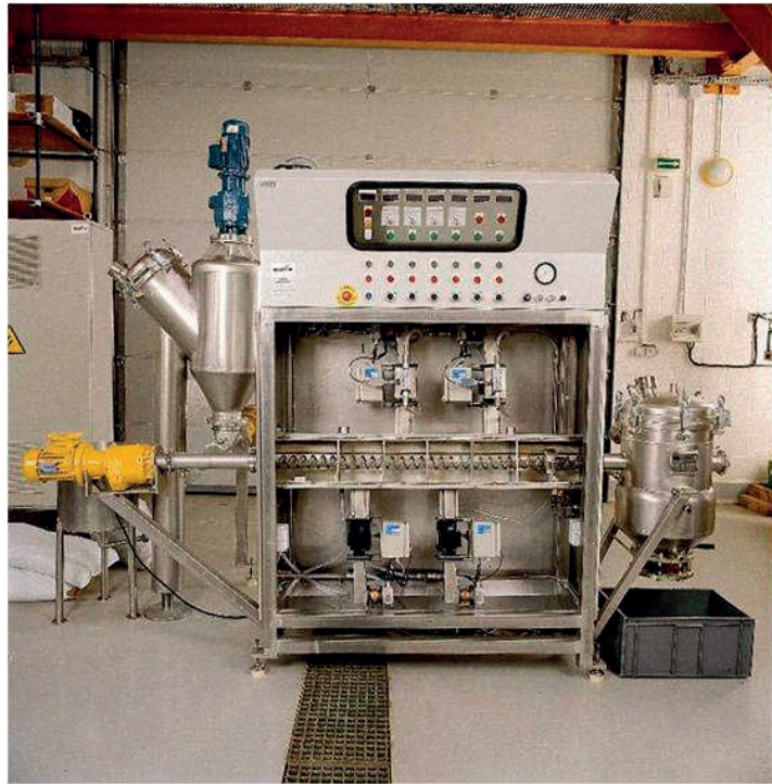
Figure 73 : Prototype du dispositif d'extraction par micro-onde en continu pour la fabrication des jus de fruits
