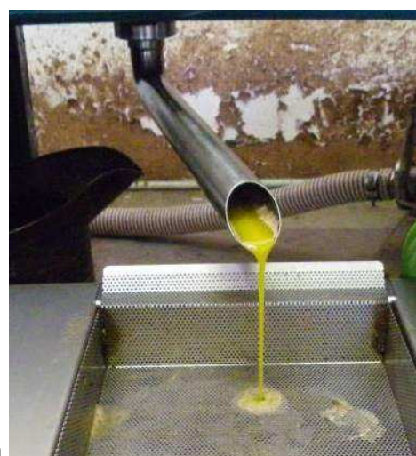
Figure 11 : (a) système à 2 phases ouvert, (b) huile d'olive à la sortie du système
