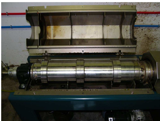
Figure 11 : (a) système à 2 phases ouvert, (b) huile d'olive à la sortie du système
