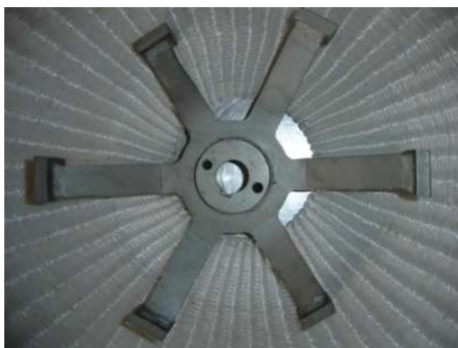
Figure 3 : Marteaux à 6 bras métalliques
